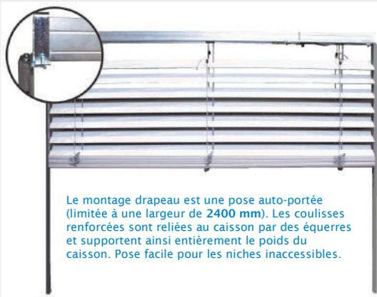
Le montage drapeau est une pose auto-portée (limitée à une largeur de 2400 mm). Les coulisses renforcées sont reliées au caisson par des équerres et supportent ainsi entièrement le poids du caisson. Pose facile pour les niches inaccessibles.
