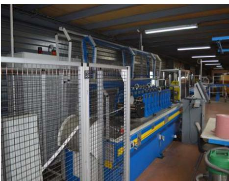
la forme courbée caractéristique de la lame S80P. La longueur profilée est alors découpée à la cote requise pour le tablier de volet roulant, puis transférée sur la table d'assemblage automatique où les lames sont emboîtées et verrouillées latéralement des deux côtés pour constituer un tablier homogène et durable.
