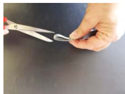
Faire une entaille dans la sangle avec une paire de ciseaux.
