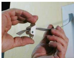
Glisser la sangle dans le guide et le fixer.
