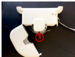
libérer le ressort Enrouler la sangle avec douceur, fermer puis fixer l'enrouleur.
